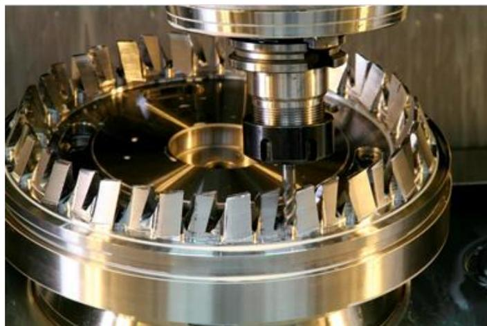
**Fig. N°02-16** – Fresatura denti con macchina CNC
